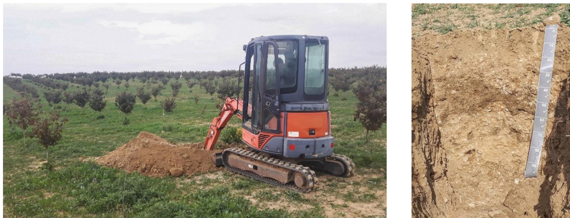
Figura 4.1. Esempio di escavazione di un profilo con impiego di escavatore, presso un appezzamento coltivato a nocciolo nell'azienda sperimentale Corte Migliorina.
