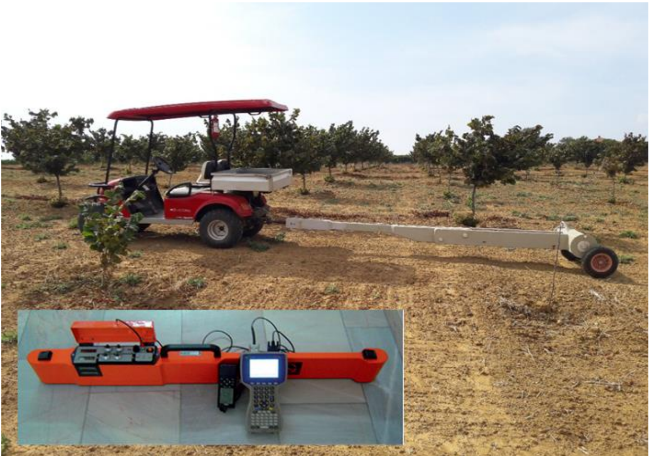
Figura 4.3. Sensore ad induzione elettromagnetica EM38-MK2 e carrello di trasporto in campo utilizzato per il rilevamento.
