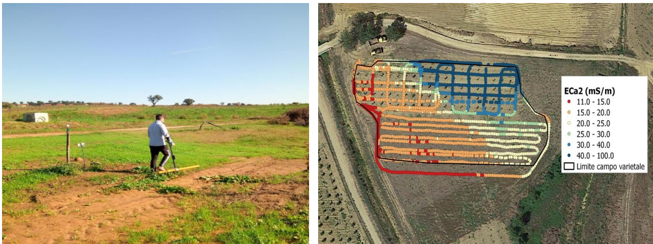
Figura 1.1. Trasporto del sensore Mini-Explorer GF-instruments (a sinistra), e mappa della conducibilità elettrica dei suoli con percorso effettuato (a destra).
