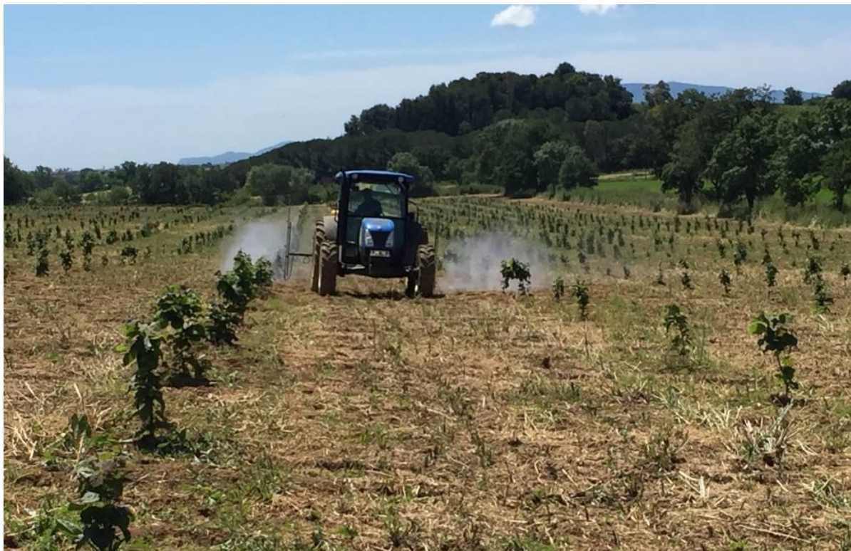
Figura 3.2. Esempio di interventi di somministrazione dei nutrienti per via fogliare con impiego di atomizzatore.
