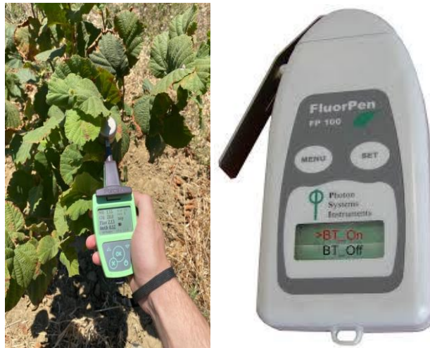
Figura 3.5. Esempio di “pinzata” in campo con impiego di analizzatore fogliare Dualex Plus nelle piante oggetto nutrizione fogliare sperimentale (sx = a sinistra), e dispositivo PAR-FluorPen FP 110-LM/D utilizzato durante i rilievi ecofisiologici di campo (dx = a destra).
