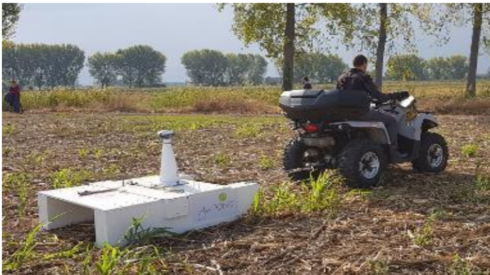
Figura 4.6. Impiego dell'apparecchiatura EMAS della Agri_SOING utilizzata per il rilevamento della resistività elettrica.
